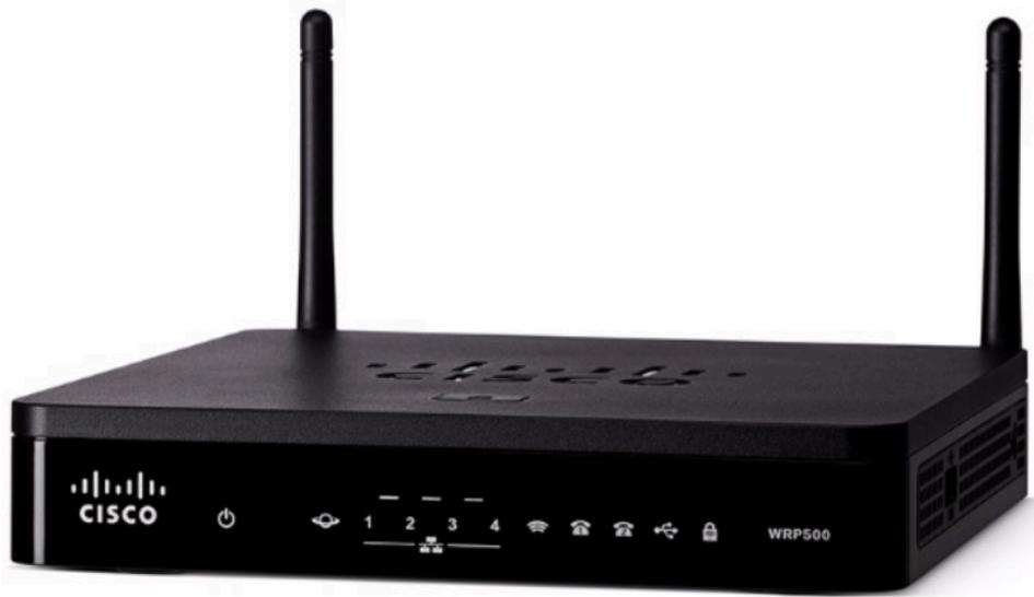
Los routers inalámbricos domésticos y de pequeñas empresas integran las funciones de un router, un switch y un punto de acceso en un solo dispositivo.
